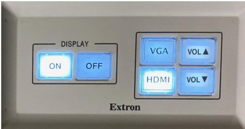
**3 –Le vidéoprojecteur s'allume par défaut sur la source entrante HDMI (détection des sources VGA et HDMI automatique sur cette entrée)**
